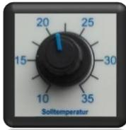
Mit dem Drehknopf wird die Solltemperatur eingestellt
